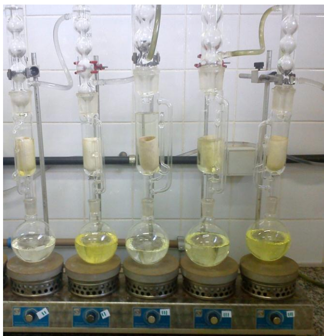
Figura 2 – Extrator soxhlet utilizado nas extrações de gordura de pena de frango.
