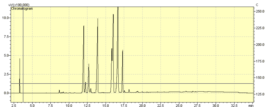
Figura 3. Cromatografia do biodiesel produzido a partir da gordura de pena de frango de corte.
