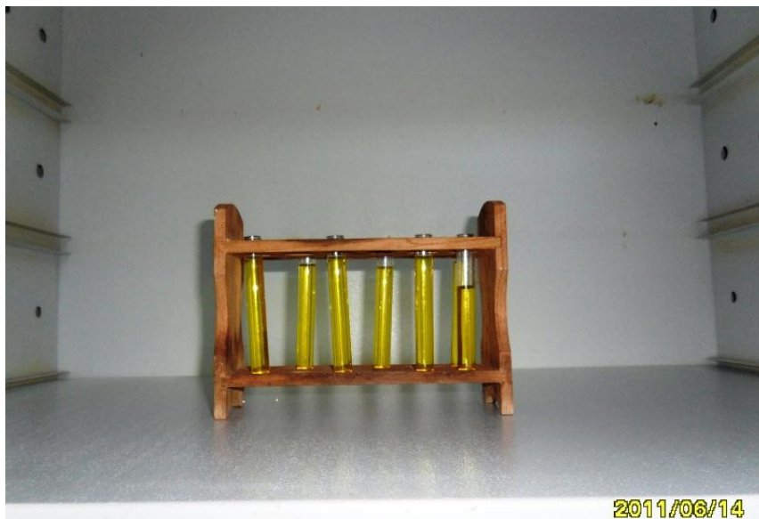
Figura 3 – Gordura de pena de frango a 105 °C para remoção da umidade.
