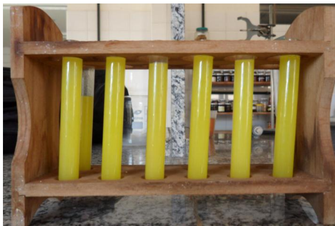
Figura 4 – Gordura extraída de penas de frango de corte.
